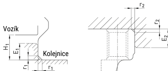
Tabulka 12.11: Výšky osazení a zaoblení hran – výrobní řada WE/QW
